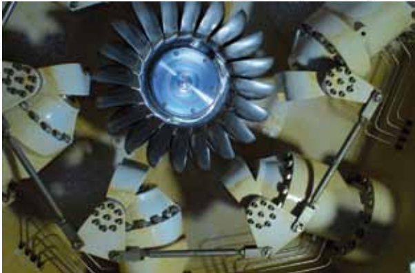
Turbinenrad mit fünf Düsen und Strahlablekern
